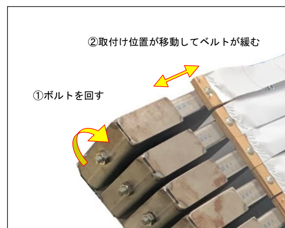
図 2 ベルトの張力調整
